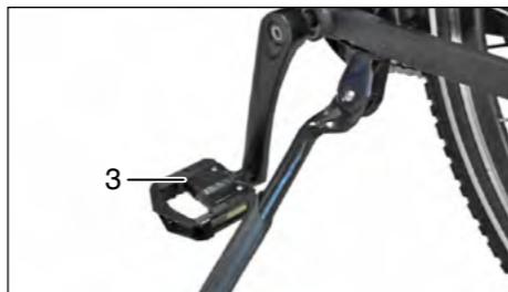
Pedal (3) für Hinterradbremse mit Rücktrittbremse
