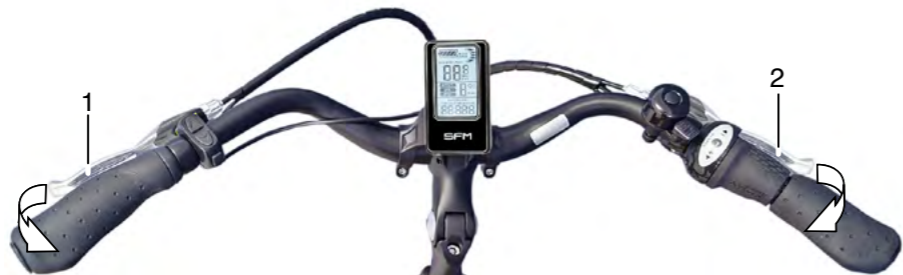
Handbremshebel (1) für Vorderradbremse
